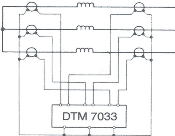
Figure 1 - Protection différentielle longitudinale de machine
