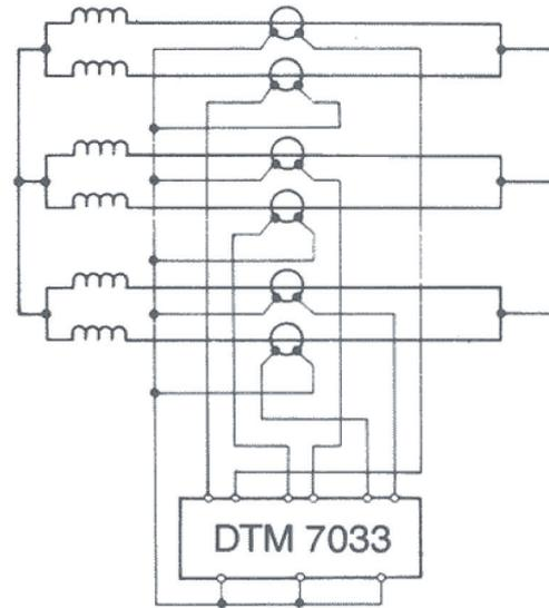
Figure 2 - Protection différentielle transversale de machine à double enroulement
