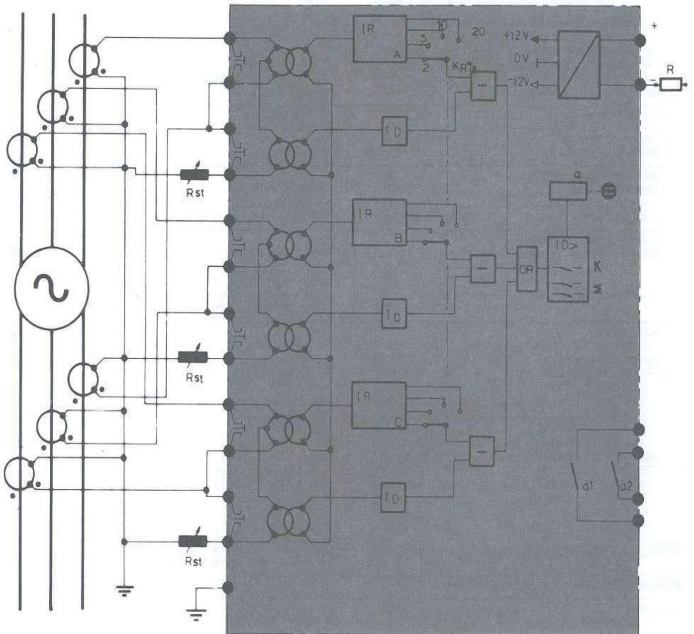
Figure 3 - Schéma de fonctionnement simplifié et de raccordement
