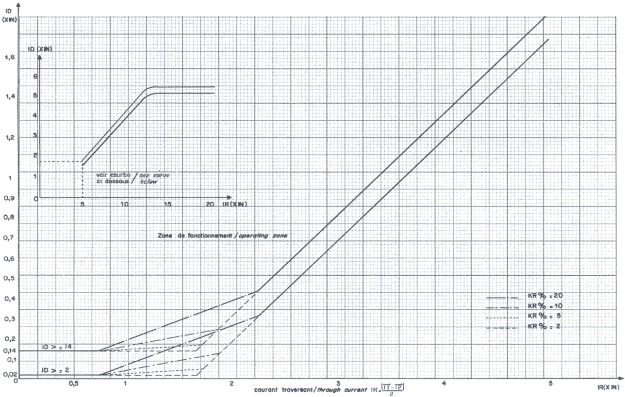
Figure 4 - DTM 7033 - Courbes de fonctionnement / Operating characteristics
