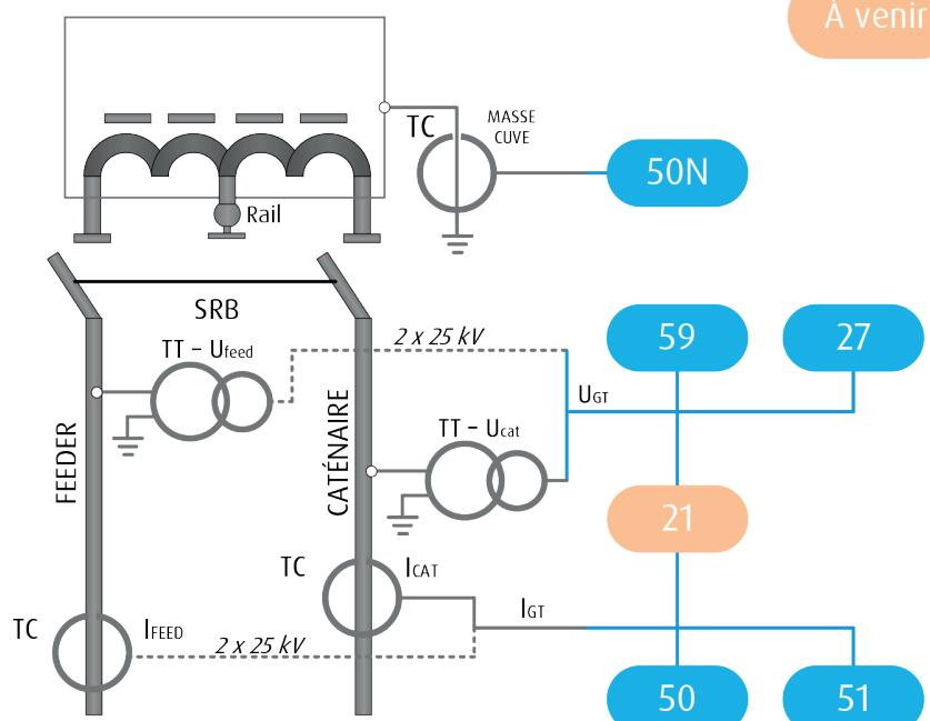
NB : les fonctions [27] / [50] / [51] / [59] utilisent indifféremment des TC/TT en amont ou en aval du transformateur.
