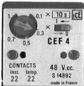
La temporisation est définie par la valeur d'ajustement du potentiomètre (0,1 à 1) multipliée par le coefficient du commutateur (1 ou 8) multipliée par le calibre du relais (1 s - 10 s - 10 min - 30 min).
