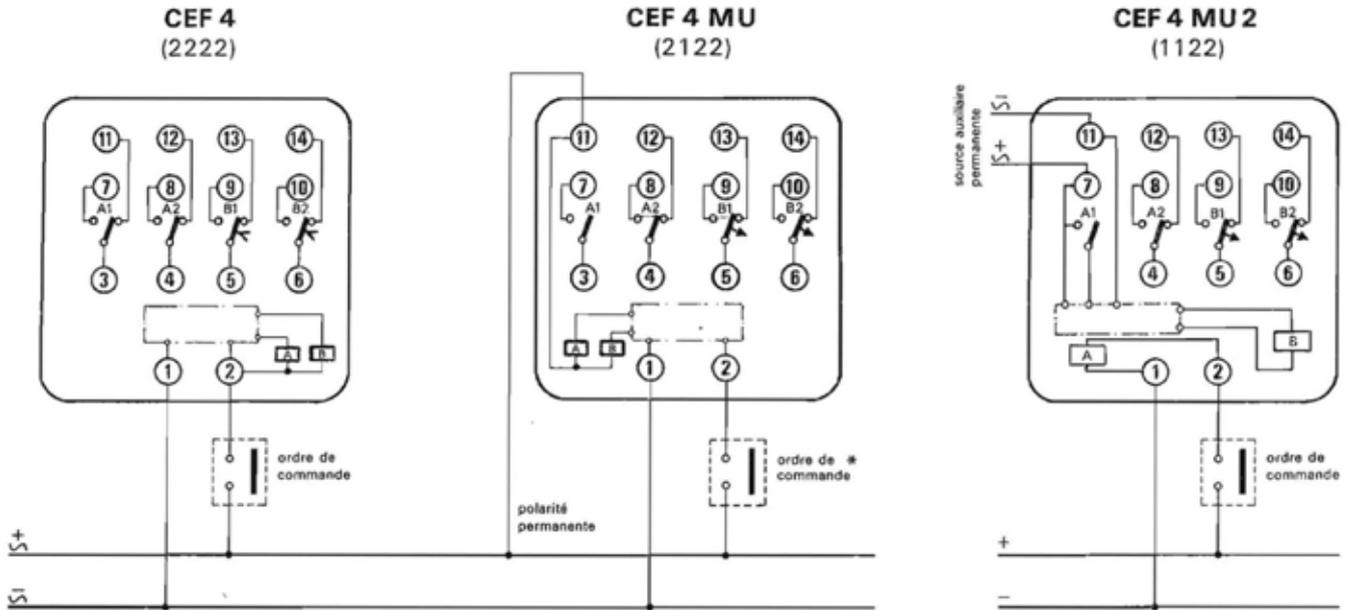
**\*REMARQUE IMPORTANTE:** En alimentation alternative, le contact de commande ne doit alimenter que le relais CEF4MU à l'exclusion de toute autre charge.
