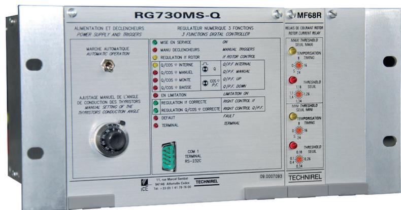
Le régulateur **RG730MS-Q** est un régulateur PID numérique destiné au contrôle de l'excitation des moteurs synchrones de moyenne et forte puissance.
